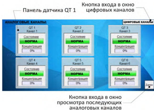
Рисунок А.8 – Окно просмотра состояния аналоговых каналов
