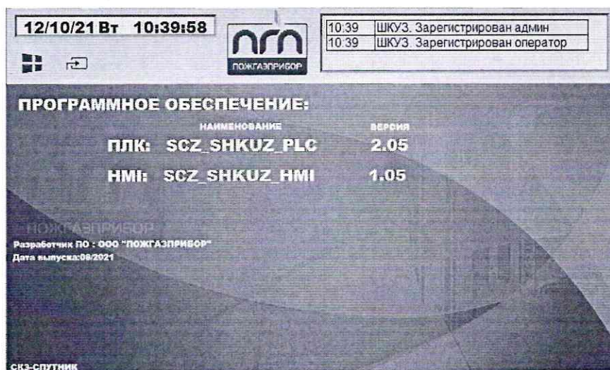
Рисунок 1 – Окно просмотра версий ПО графической панели ШКУЗ-ППП
