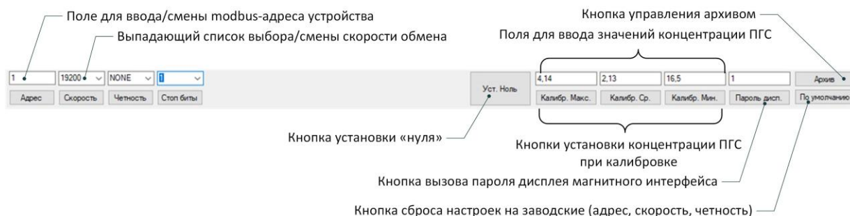
Рисунок Ж.6 – Панель инструментов для работы с выбранным в таблице устройством
