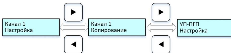
Рисунок 8 – Циклограмма выводимых сообщений на дисплей при настройке УП-ПГП с канальными платами при *выключенном* канале
